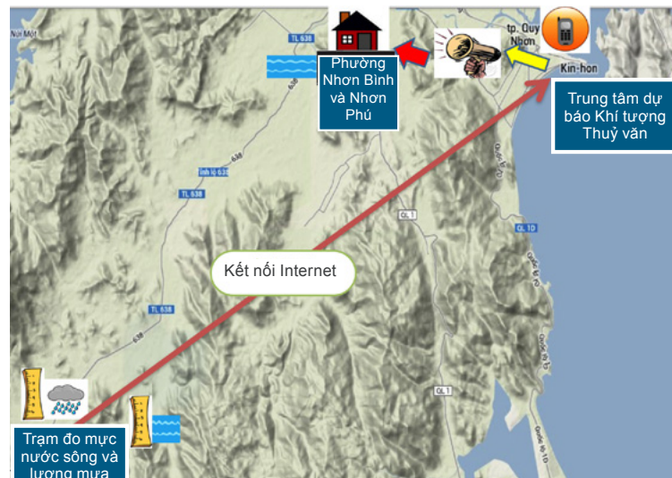
HÌNH 2 HOẠT ĐỘNG CỦA HỆ THỐNG CẢNH BÁO LŨ SỚM
